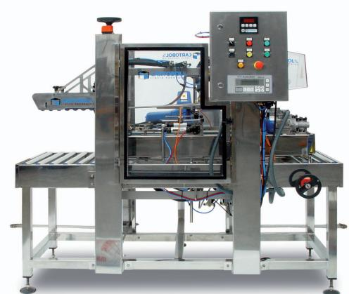
Máquina **ECOPACK HOT MELT** es una cerradora automática con cola caliente, ideal para incorporar en final de línea.
